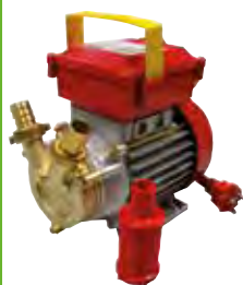
ELECTROBOMBA BEM20 ROVER POMPE 8032706073271 Trasiego de líquidos decentados. Autoaspirante. Altura máxima de aspiración 3m ( sin válvula de pie ) 8m ( con válvula de pie ) - Monofásica 230 V - 50 Hz- CUERPO DE BOMBA LATÓN, RODETE LATÓN, EJE MOTOR INOX AISI 304 - se suministra con interruptor de 3 posiciones, cable, conector y racores. 79'90
