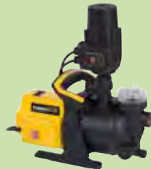
GRUPO DE PRESIÓN AUTOMÁTICO 5400338071553 600W. Con prefiltro incluido. Caudal máximo 3000 lt/h. Arranque y paro automático al abrir y cerrar el grifo. 129'90
