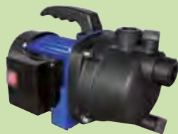
BOMBA SUPERFICIE 600W 8424385252007 Bomba superficie 600w, autoaspirante, a 7m, cable de 1,2m, lista para usar, altura max 35m, caudal max 3000l/h. Cuerpo en tecnopolimero, salida 1". Diámetro max de partículas 0,5mm. 69'95
