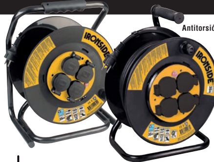
ENROTLLACABLES IP44. Amb protecció tèrmica. 4 preses amb protecció infantil. 3x2,5 mm 2 . 16A-230V. Potència màxima enrotllat: 1300 W. Potència màxima totalment desenrotllat: 3600 W. IP44. 9685586 25 m 82'60 + IVA = 99'95 9685588 35 m 123'14 + IVA = 149'00 9685587 40 m 147'93 + IVA = 179'00
